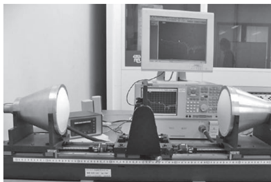
写真2 レンズ法(材料定数の測定用)
